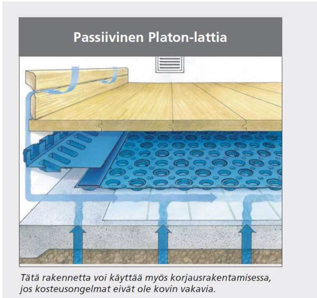
Kuva 4. Passiivinen Platon-lattia. (Nordic Waterproofing Oy 2014)
