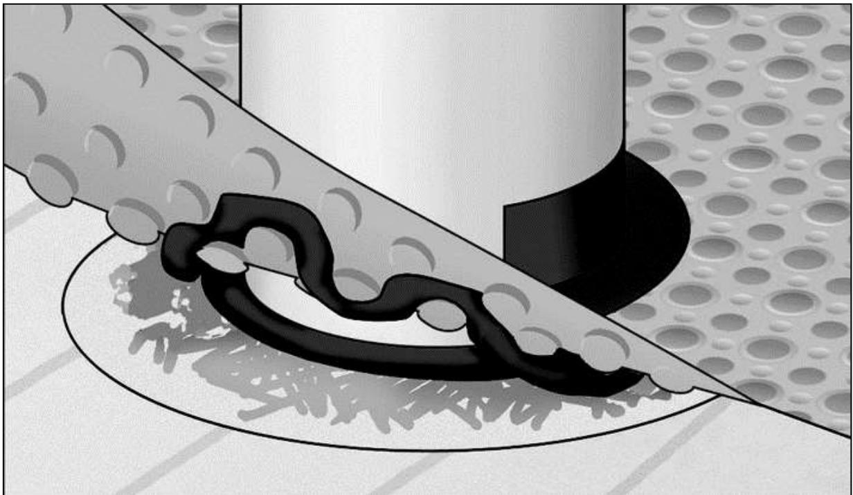
Kuva 9. Lämpivientien tiivistäminen. (Nordic Waterproofing Oy 2014)
